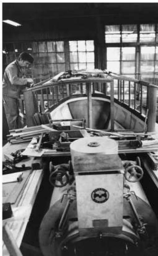
Rechts: Baubeginn im Winterlager Seedamm Marina bei Pfäffikon/Schwyz der Yachtwerft Faul, Horgen. Der von der Firma König, Arbon, gebaute Schiffsdampfkessel schottischer Bauart (Zweizug). Photo vom 10. Januar 1987.
