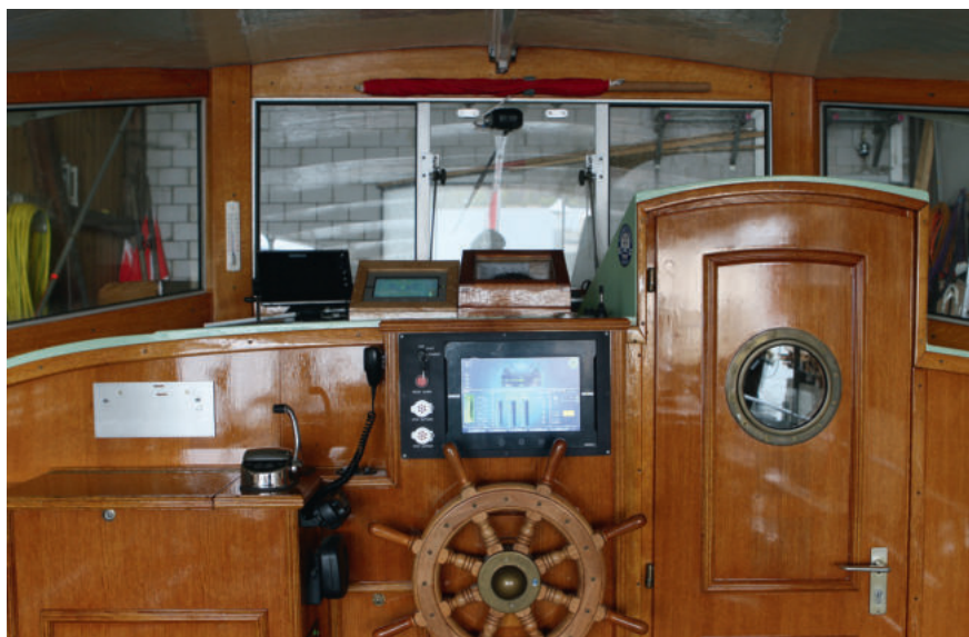
Steuerstand mit Display für den Steuermann während der Fahrt.
