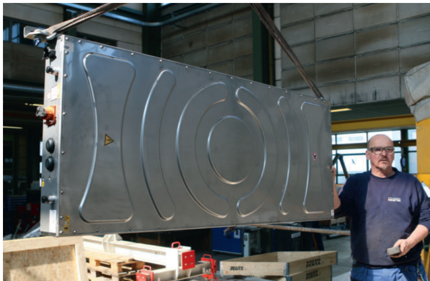
Eine der drei Akazem-Batterien mit 33 kWh Kapazität.
